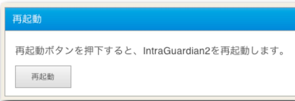
\* 再起動中は本製品のステータスLED1とステータスLED3が赤点滅します。再起動が終了するとステータスLED1が緑点滅に変わりますので、あらためてブラウザで本製品の管理画面にアクセスしてください。
