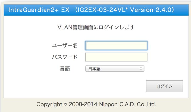
「ユーザー名」と「パスワード」を入力して、[ログイン] ボタンをクリックして管理画面にログインします。ユーザー名とパスワードは出荷時に以下の通りに設定されています。
