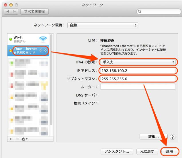
IntraGuardian2+ を接続しているネットワークインターフェースを選択し、IPv4の設定を「手入力」、IPアドレスを「192.168.100.2」、サブネットマスクを「255.255.255.0」と入力します。
